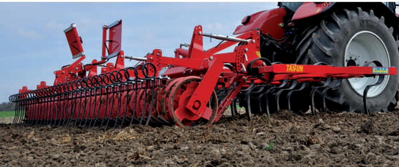
Les rouleaux arrière sont réglables en hauteur par brochage. Montées entre la dernière rangée de dents et les divers rouleaux arrière, des dents niveleuses doubles assurent un effet de finition remarquable.
