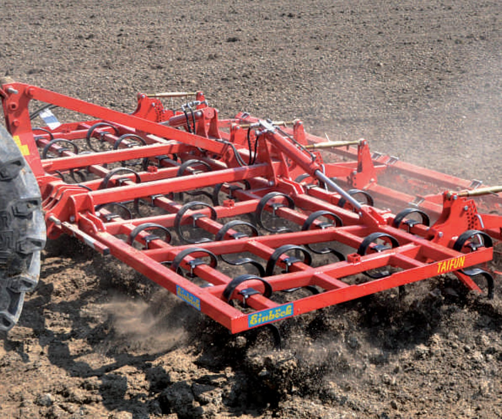
La **profondeur de travail** du TAIFUN est contrôlée simultanément par la bielle de 3<sup>ème</sup> point et le rouleau émetteur arrière. Toute la pression au sol est reportée sur le rouleau émetteur ce qui garantit à la machine une grande souplesse de fonctionnement.
