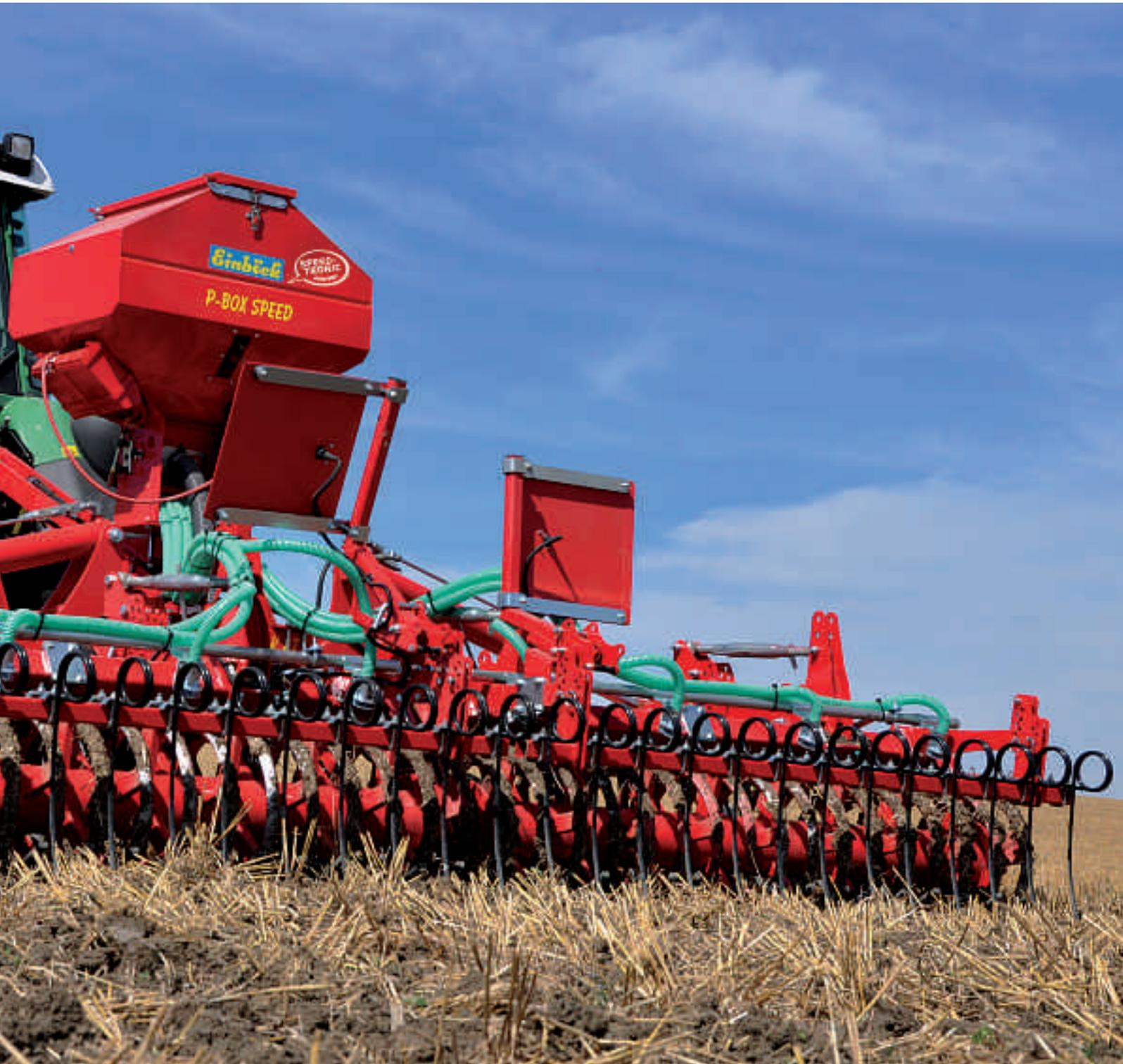
Simple et faciles à régler, les semoirs **PNEUMATICBOX** ou **P-BOX SPEED** permettent de semer tous les types et mélanges de semences usuelles jusqu'à environ 5 mm de grosseur. Selon le dosage et la vitesse d'avancement, il est possible de semer de 1 à 300 kg de semence par ha.
