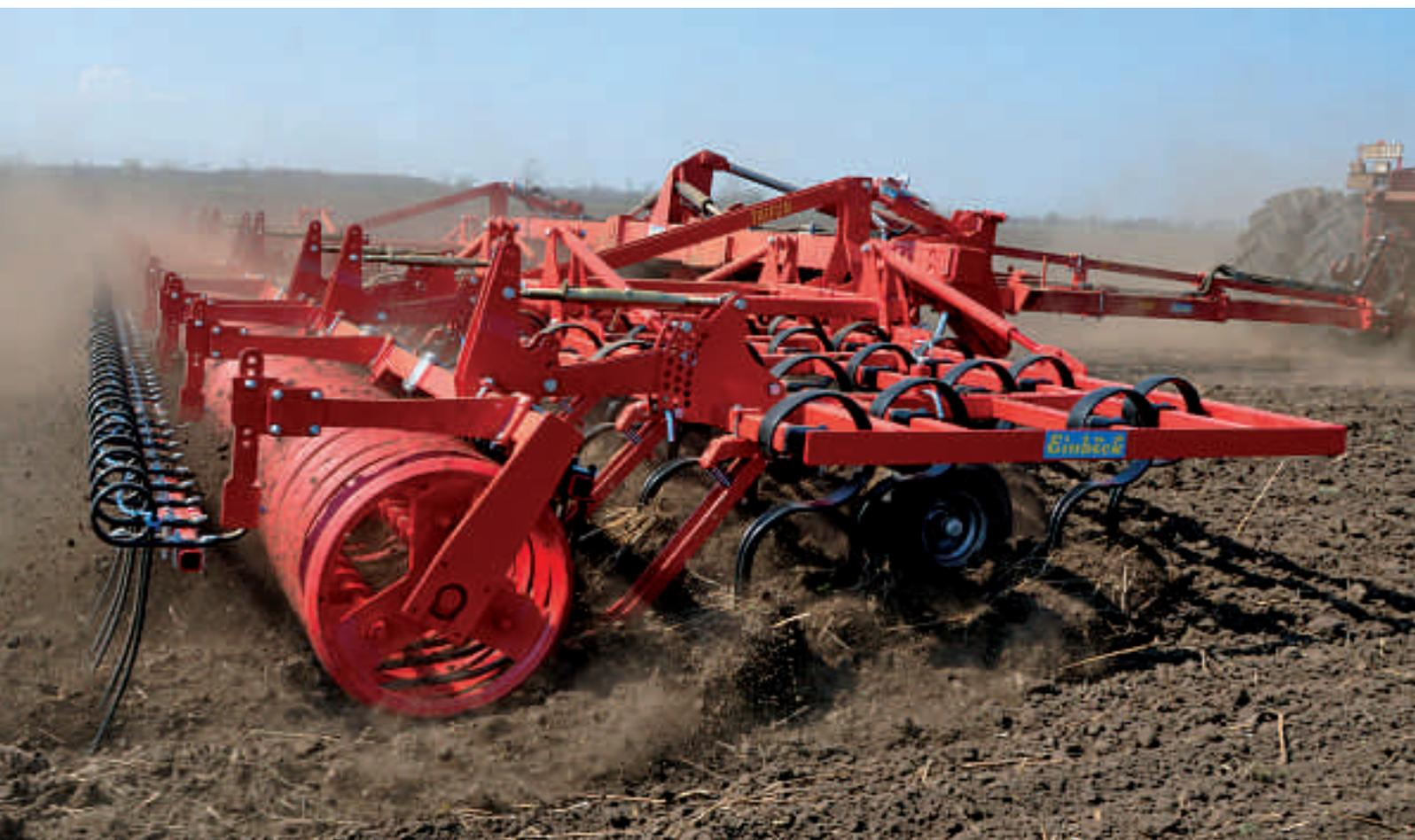
Les utilisateurs qui souhaitent utiliser des tracteurs légers, peuvent dissocier le semoir du TAIFUN et l'atteler sur le relevage du tracteur pour s'en servir en solo.
