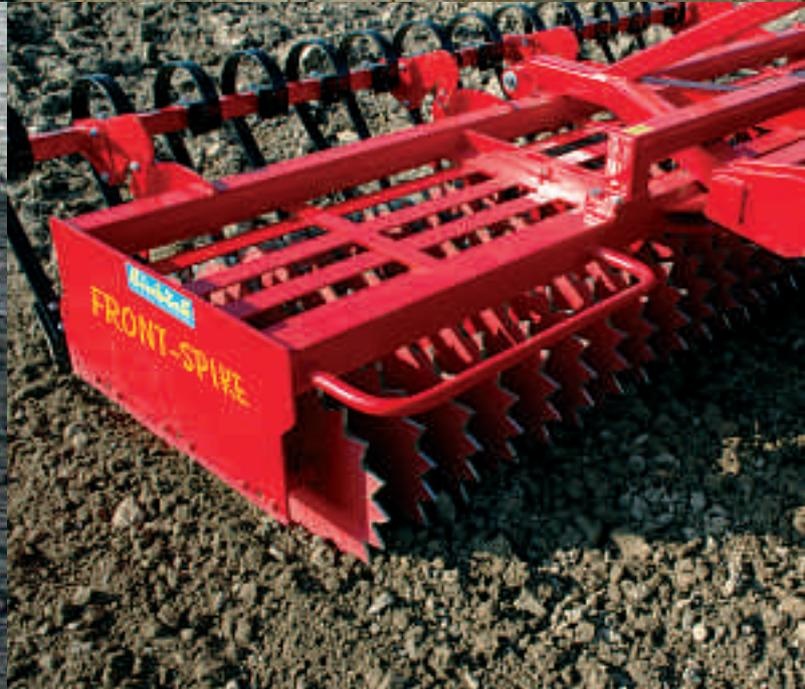
Le FRONT-STAR est parfaitement adapté au travail des terres très lourdes et humides. Il est équipé d'une planche niveleuse montée sur ressorts et réglable en hauteur. Celle-ci écrase les grosses mottes et réalise un premier nivellement du sol. Puis suivent trois rouleaux en étoiles avec de grands intervalles entre les pointes qui, sans risques de bourrage, écrasent et cassent les mottes.
