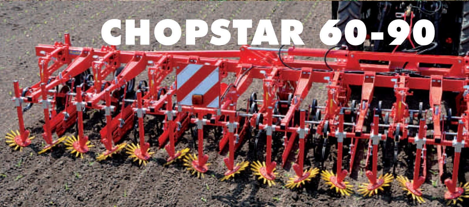
Pour les grandes largeurs, le châssis porteur est équipé d'un repliage hydraulique.
