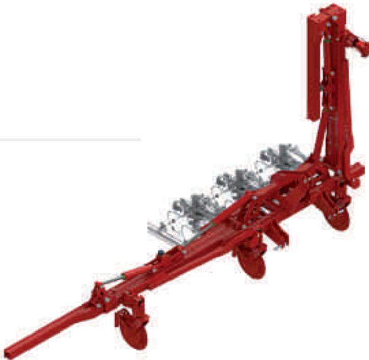
**Châssis arrière avec repliage en portefeuille pour limiter la largeur de transport.**
