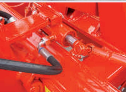
Le vérin de **pré-guidage hydraulique** accentue le guidage par le troisième point de la machine. A la fin de la parcelle il faut toujours actionner le vérin dans l'autre sens. Recommandé à partir de 6% de dévers.
