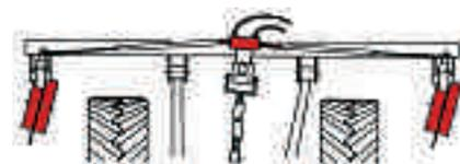
Vérin de pré-guidage hydraulique
