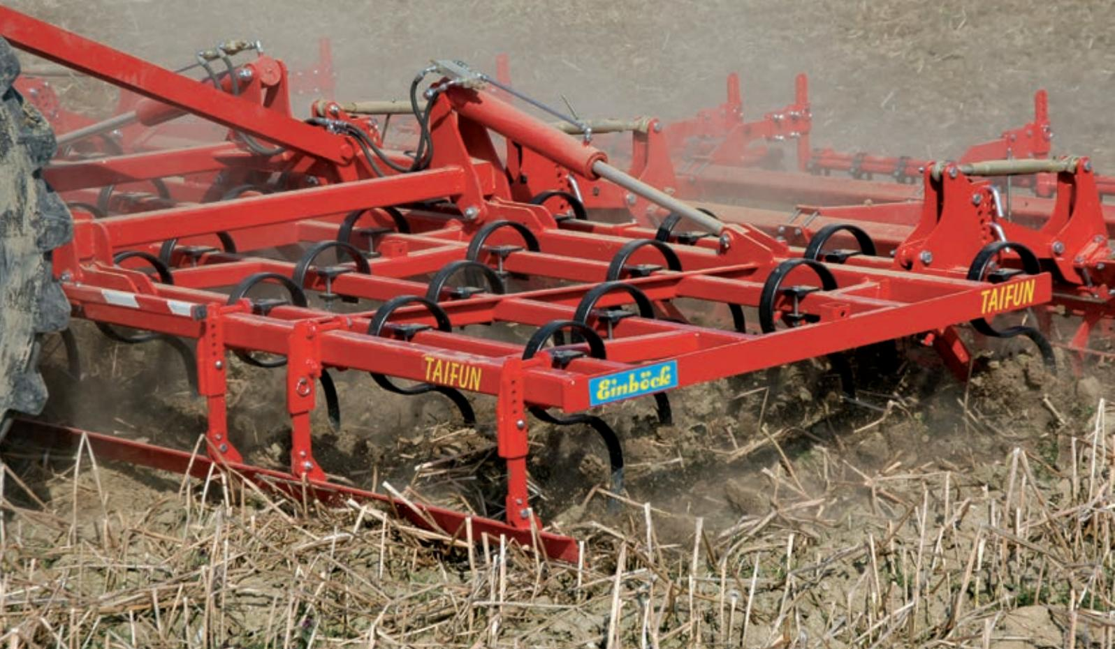
Fixée sur la partie avant du châssis, la planche niveleuse est réglable en hauteur par brochage. Elle intègre également un réglage en fonction „traînée“ ou „poussée“ qui permet d'écraser les mottes, de niveler le sol et de combler les traces de tracteur. Il s'en suit une bonne stabilité de travail et une parfaite régularité du terrage. C'est en particulier lors d'une préparation de lit de semis que l'utilisation de la planche niveleuse est recommandée.
