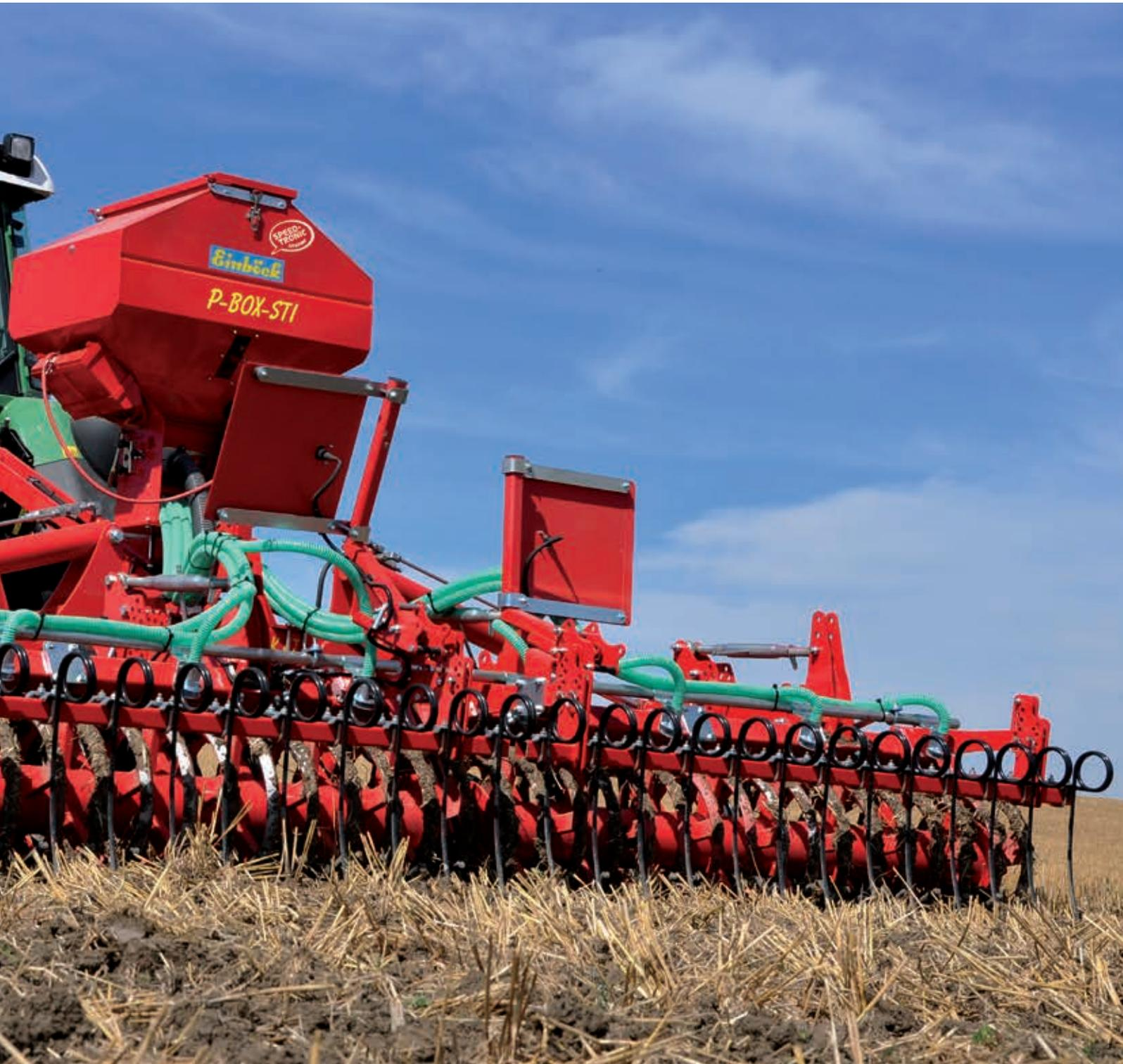
Simple et faciles à régler, les semoirs P-BOX-MD, P-BOX-ED ou P-BOX-STI permettent de semer tous les types et mélanges de semences usuelles jusqu'à environ 5 mm de grosseur. Selon le dosage et la vitesse d'avancement, il est possible de semer de 1 à 300 kg de semence par ha.
