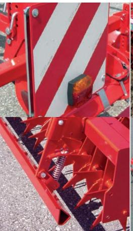
Sur le FRONT-STAR, la **planche niveleuse montée sur ressorts** est de série.
