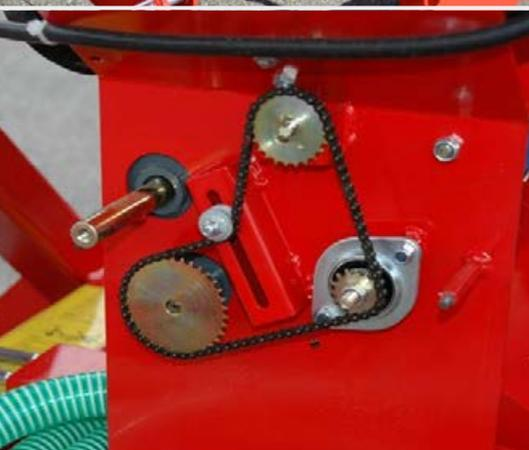
**Largement dimensionnée** et équipée d'un tendeur, la **chaîne de la transmission** à bain d'huile entraîne en continu les rouleaux doseurs et l'agitateur.
