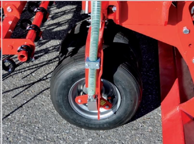
■ **Entraînement au sol** par la roue de tassage (PNEUMATICSTAR). Protégé par un tuyau, un arbre d'entraînement flexible entraîne la transmission continue à bain d'huile. Le régime est dépendant de la vitesse de rotation de la roue de tassage. Aucun autre entraînement au sol n'est justifié.
