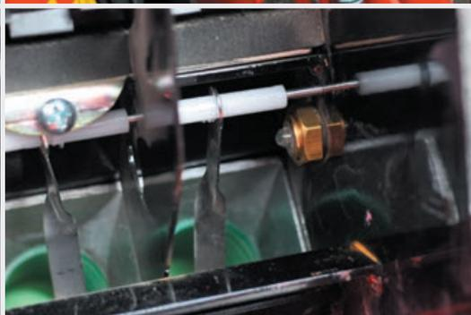
Le **capteur du niveau de la trémie** identifie quand la trémie devient vide. Le capteur travaille inductivement et alors est insensible aux vibrations.
