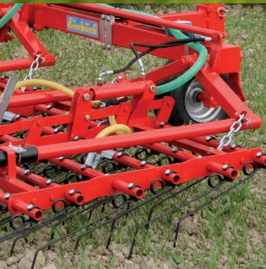
L'orientation hydraulique des dents simplifie l'utilisation du GRASS-MANAGER, de PNEUMATICSTAR ou du PNEUMATICSTAR-STI **sur des parcelles au sol hétérogène**. Facile à monter ultérieurement, cet équipement est également avantageux pour rabattre les dents en arrière lors du repliage de la machine en position de transport.
