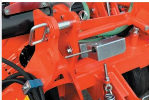
Le **capteur sur la roue** détermine précisément la vitesse (de série).
