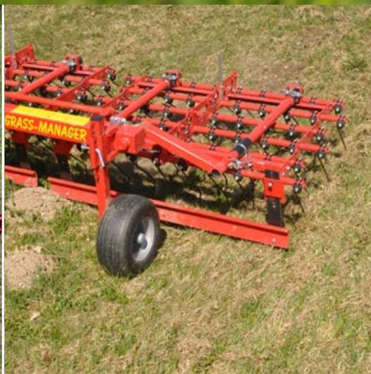
JSelon leur largeur de travail, le GRASS-MANAGER, le PNEUMATICSTAR ou le PNEUMATICSTAR-STI sont équipés de deux ou de quatre **roues de jauge à pneus**. Réglables en hauteur, ces roues évitent, sur terrains souples, une pénétration trop profonde des dents dans le sol.
