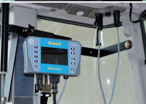
Les **capteurs de la surveillance du débit d'air** détectent, si un ou plusieurs tuyaux sont bloqués et dans ce cas montre un erreur sur la commande (en option).
