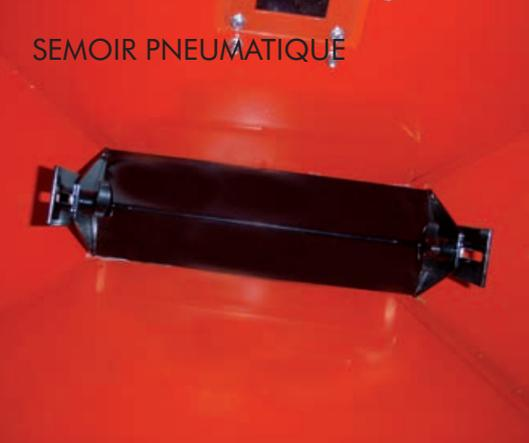
Pour les semences lourdes il est recommandé de mettre en place **la tôle de retenue** à monter juste au-dessus de l'agitateur.
