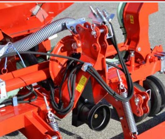
Dotée d'un débit d'air plus important, la **turbine mécanique** permet de semer des semences lourdes à des vitesses d'avancement rapides et jusqu'à 6 m de largeur de travail. Cette version est conseillée pour les entreprises de travaux agricoles et les CUMAS.
