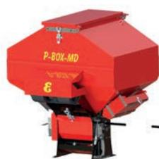
Le PNEUMATICSTAR-PRO peut être équipé soit d'un semoir P-BOX-MD avec entraînement mécanique soit avec le P-BOX-STI, un semoir avec lequel le débit de semences est réglé électroniquement par la commande SPEED-TRONIC (voir pages 50 - 51).
