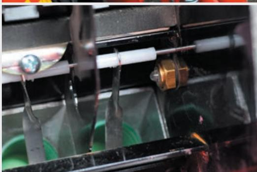
Les **capteurs de la surveillance du débit d'air** détectent, si un ou plusieurs tuyaux sont bloqués et dans ce cas montre un erreur sur la commande.
