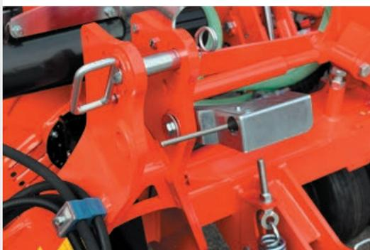
Le **capteur GPS**, monté sur le couvercle de la trémie, est une option pour déterminer exactement.
