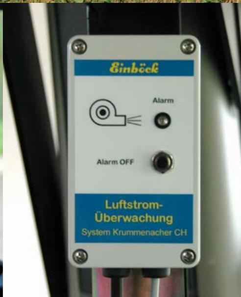
Le **module de commande** permet l'arrêt et la mise en marche de la turbine sans quitter le poste de conduite.
