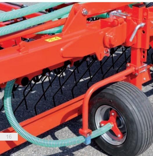
**Entraînement au sol par roue pneu**
