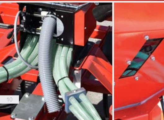
Ouverture et tuyau de vidange flexible situés du côté gauche
