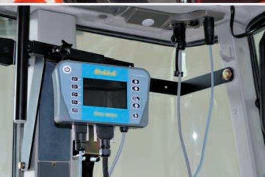
L'alimentation du courant est guidé par l'électronique du tracteur. La prise de signalisation à **7-pôles permet de transmettre** les valeurs des capteurs du tracteur.
