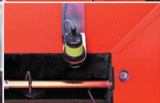
Le **capteur du niveau de la trémie** identifie quand la trémie devient vide. Le capteur travaille inductivement et alors est insensible aux vibrations.
