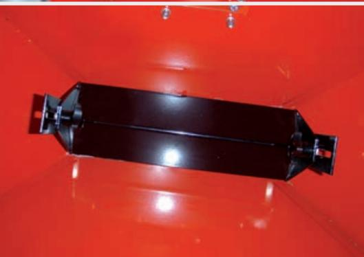
Pour les semences lourdes il est recommandé de mettre en place le **volet de retenue** à monter juste au-dessus de l'agitateur.
