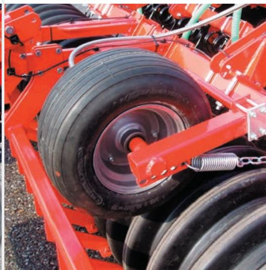
Entraînement pendulaire avec inversion de la commande - avec roue-coutres à la place de la version standard
