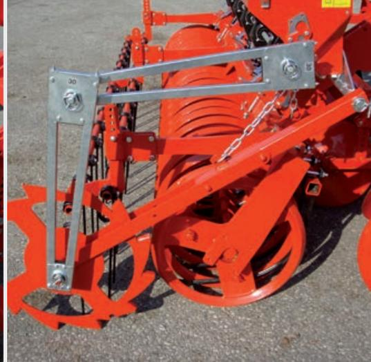
Le bras de la roue d'entraînement au sol est réglable en longueur. Grâce à son grand diamètre, la roue au sol garantit, y compris sur des reliefs prononcés, un entraînement précis de la distribution du semoir. Les cassettes de transmission réversibles permettent un réglage rapide du dosage de la distribution.
