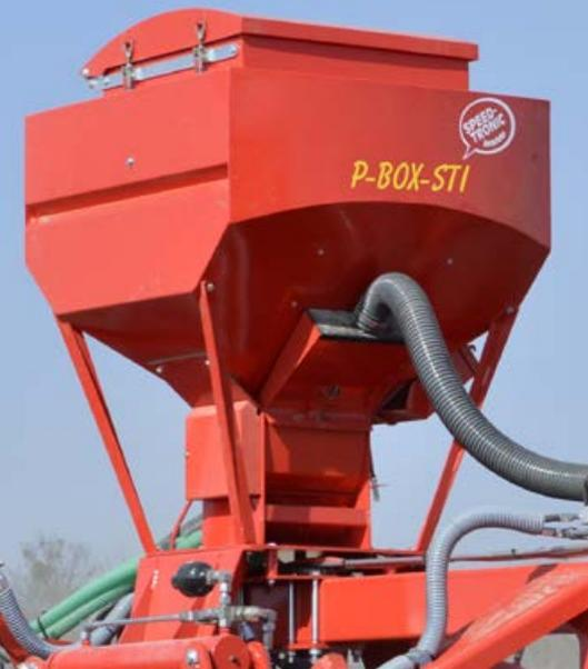
Sur demande, les semoirs P-BOX-MD, P-BOX-ED et P-BOX-STI peuvent être équipés d'une **trémie de 500 litres** (avec renforts de trémie et ouverture extra-large).
