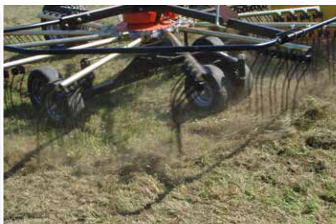
Photo 12 : éviter de travailler trop profondément le sol en cas d'andainage
