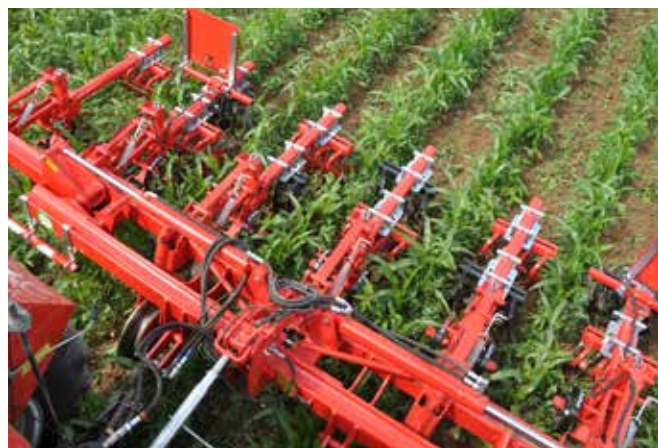
Binage arrière avec étoiles de binage et pilotage 3e point
