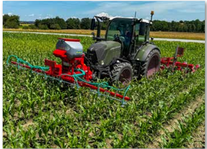
Sous-semis dans le maïs avec une bineuse et barre de semis avant
